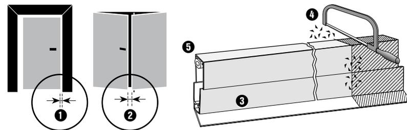
Dichtung kürzen im **ausgelösten Zustand**:
