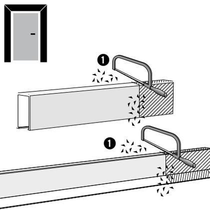
① Überströmkanal / Dichtung kürzen, Späne entfernen;
